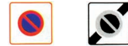
Entrée de zone à stationnement interdit Sortie de zone à stationnement interdit
